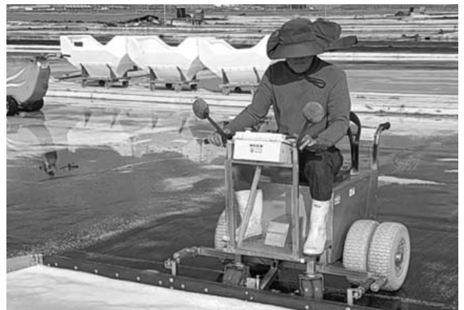
소금을 염전가장자리로 모으는 장비인 '탐승형 전동대파기(왼쪽)'와 소금을 이동수레로 옮겨 담는 장비인 '양용 자동채염기'. (신안군 제공)
