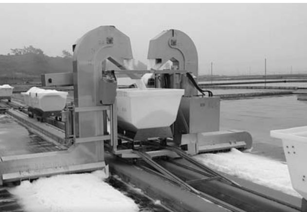
소금을 염전가장자리로 모으는 장비인 '탐승형 전동대파기(왼쪽)'와 소금을 이동수레로 옮겨 담는 장비인 '양용 자동채염기'. (신안군 제공)
