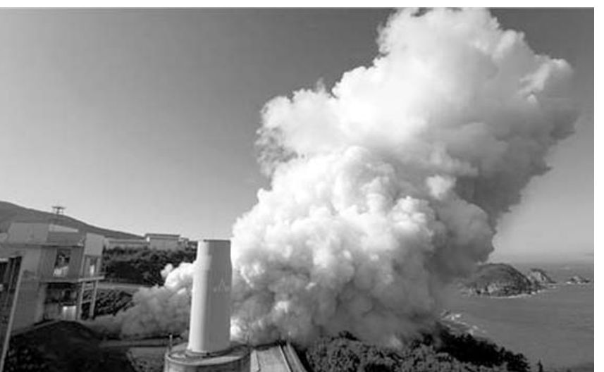
누리호 첫 엔진 연소시험...4차 발사 준비 순항 한국형발사체 누리호가 내년 하반기로 예정된 4차 발사를 위한 1단용 75급 엔진 조립을 완료하고, 지난 3일 고흥 나로우주센터에서 성능검증 수막 첫 연소시험을 실시했다. 사진은 누리호 4차 발사 비행모델(FM) 1단 엔진 수막시험. <우주항공청 제공>
